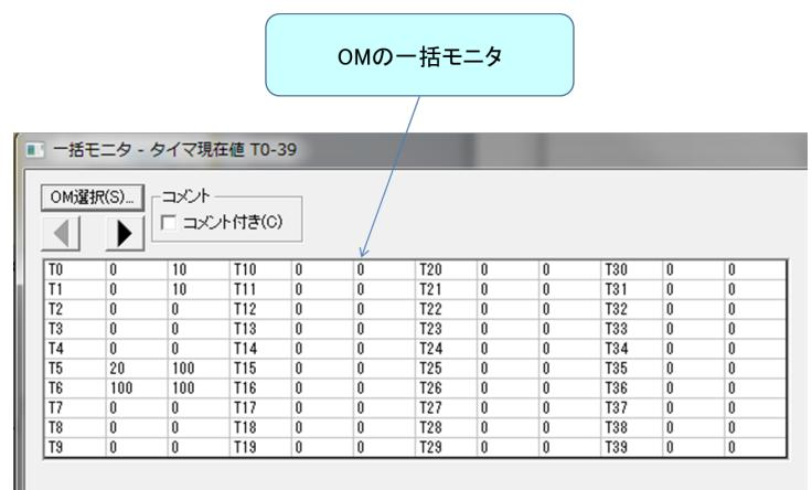
(オンラインデバッグ機能) INTALOGIC5 Runが搭載されているターゲット機器とPCをつないでオンラインでプログラム変数の現在値変更や指定条件成立時の実行停止など各種デバッグを行うことができます。
