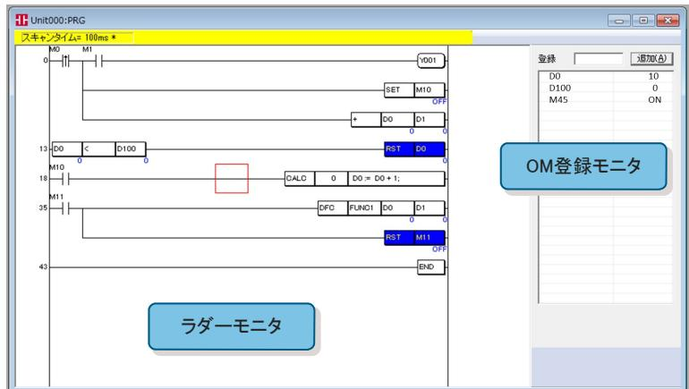
ラダーハルモニタ時は、接点/コイルのON/OFF状態モニタ表示やOM/変数の現在値モニタ表示を行うことができます。OMや変数の値を変更したり、接点のON/OFFを変更したりすることもできます。
